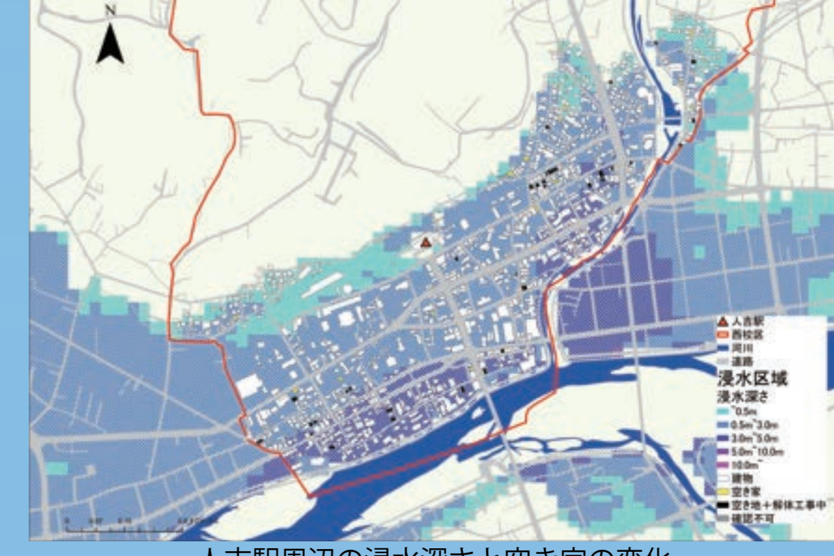
人吉駅周辺の浸水深さと空き家の変化
